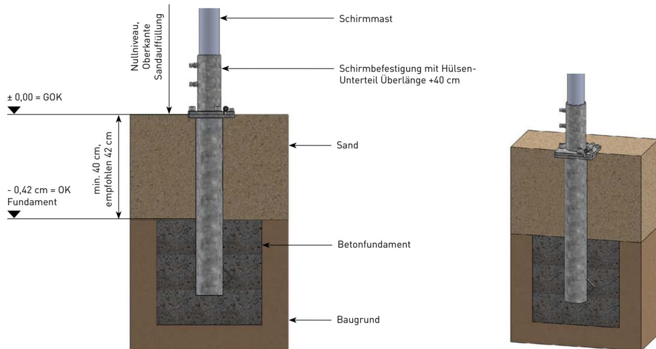
**Vorteil:** Der Schirm kann fachgerecht auf- und abgebaut werden. Das Klappscharnier hat seine volle Funktion. Es muss kein Sand bei der Montage abgetragen werden.
